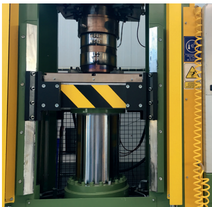
Vulcanizing pressess for rubber bladders and membranes Prensas de vulcanizado para vejigas y membranas
