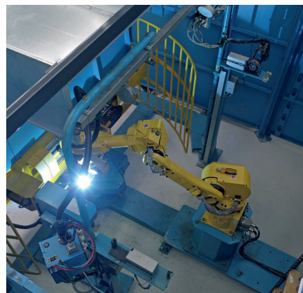
Welding robot with MIG and plasma technology Robot de soldadura con tecnología MIG y plasma
